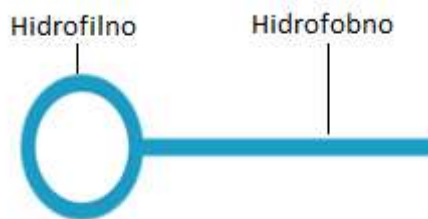
Slika 2.1. Prikaz molekule površinski aktivne tvari – tenzida, [5]
