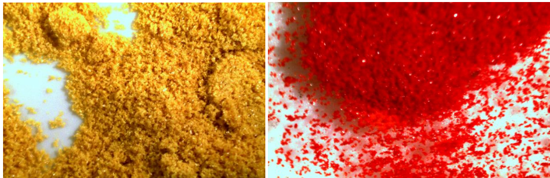
Slika 23. Kristali spoja p -D1 a) prije i b) nakon jednodnevnog izlaganja parama SO 2
