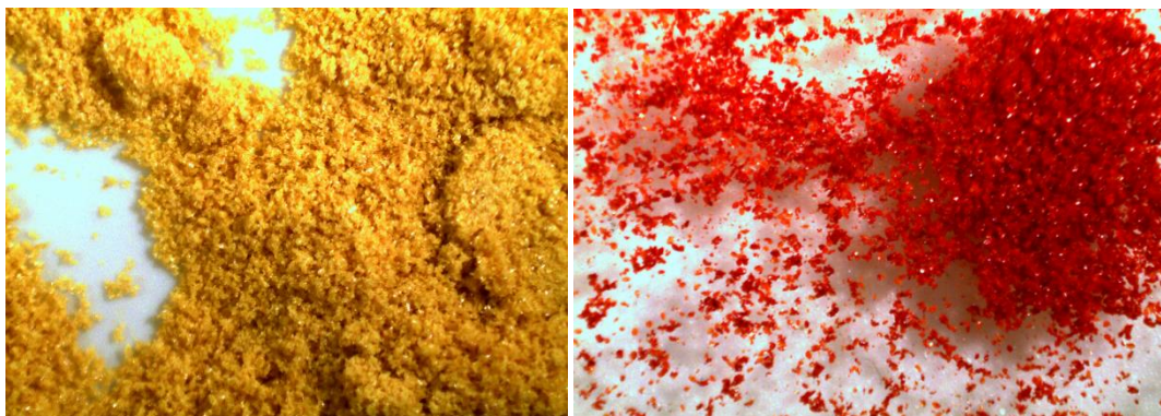
Slika 21. Kristali spoja p-DI a) prije i b) nakon jednodnevnog izlaganja parama \text{CO}_2
