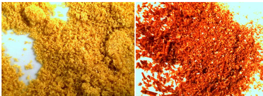
Slika 20. Kristali spoja p-DI a) prije i b) nakon jednodnevnog izlaganja parama broma
