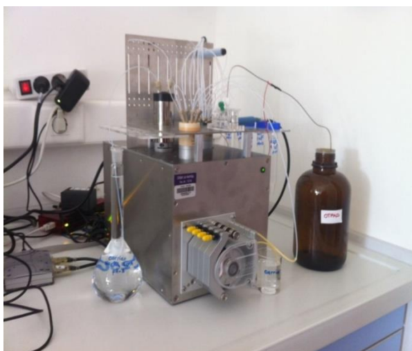
Slika 9. FIA analizator vlastite izrade
