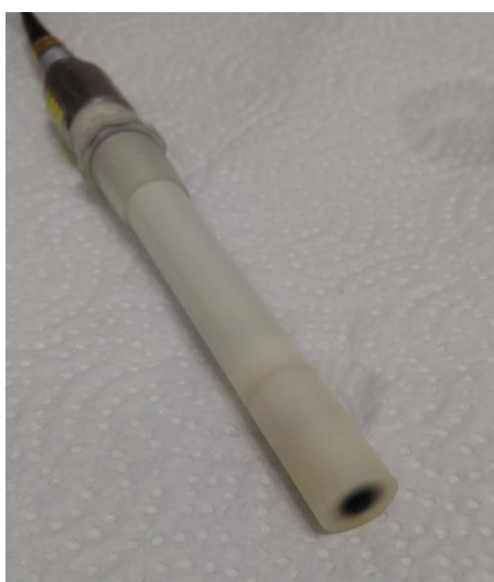
Slika 10. Ionsko selektivna elektroda (MWCNT-TODA-TPB)
