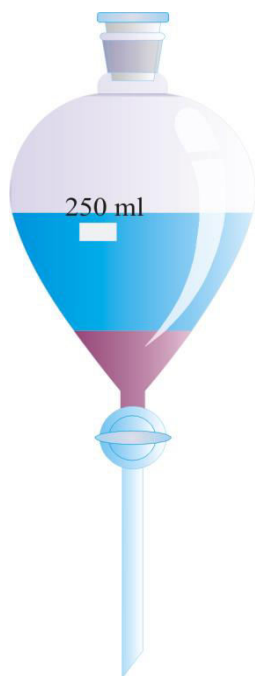
Slika 5. Lijevak za ekstrakciju [15] .
