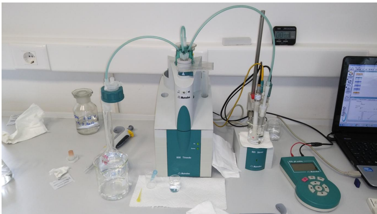
Slika 8. Prikaz aparature korištene pri titraciji
