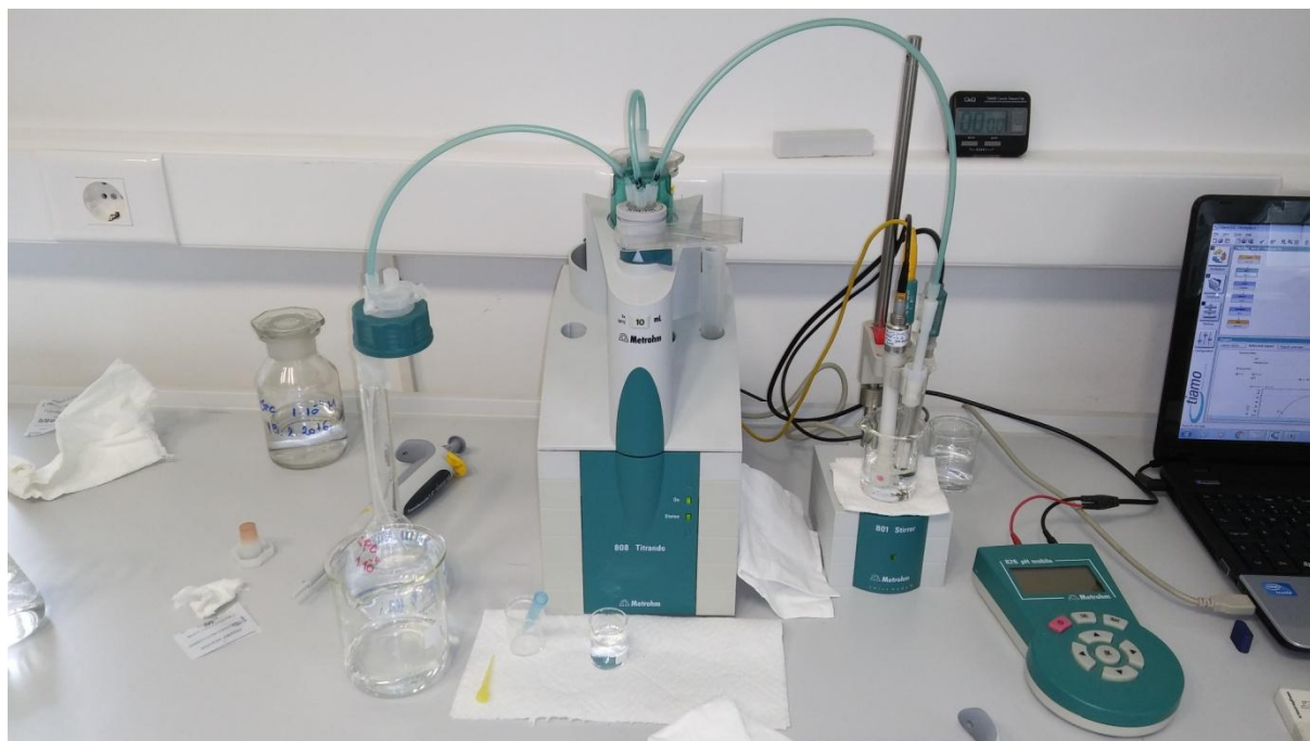
Slika 8. Prikaz aparature korištene pri titraciji
