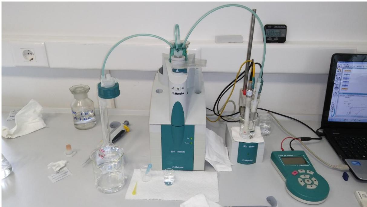
Slika 8. Prikaz aparature korištene pri titraciji
