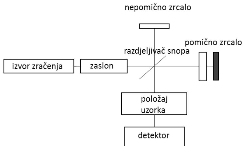
**Slika 3.** Shema FT-IR spektrofotometra.
