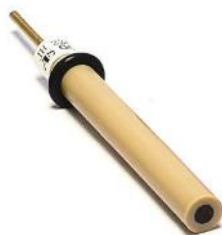
Slika 3.5. Radna elektroda od staklastog ugljika(ALS Co., Japan) [35].
