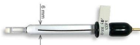
Slika 3.6. Referentna srebro/srebrov klorid elektroda (Ag/AgCl) čiji je unutrašnji elektrolit 3 \text{ mol dm}^{-3} \text{ KCl} (ALS Co., Japan) [36].
