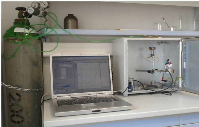
Slika 8. Prikaz aparature za voltametrijska mjerenja (PalmSens potencijostat/galvanostat)
