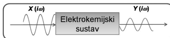
Slika 5. Shematski prikaz mjerenja impedancije.
