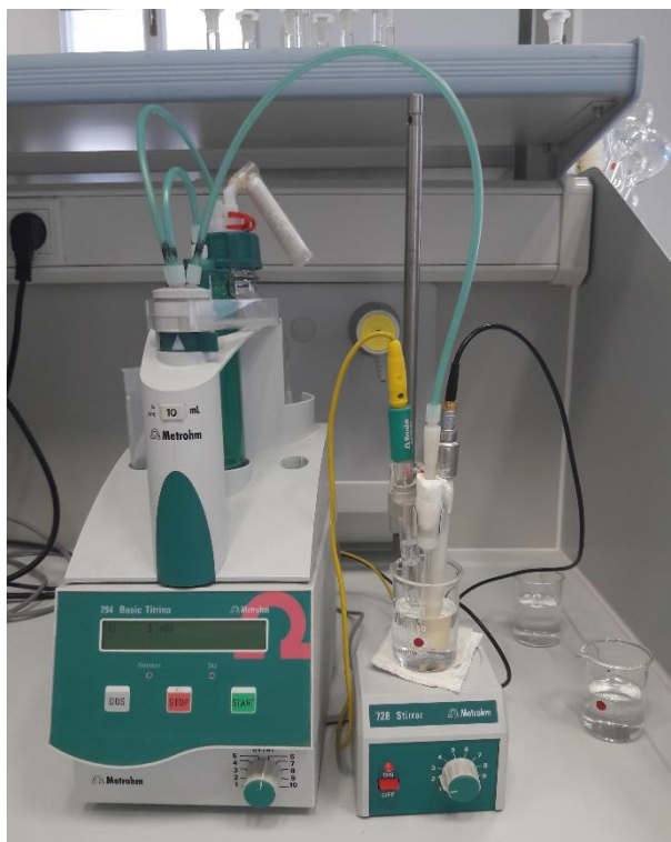
Slika 22. Korištena aparatura za titracije i ispitivanje odzivnih karakteristika senzora.
