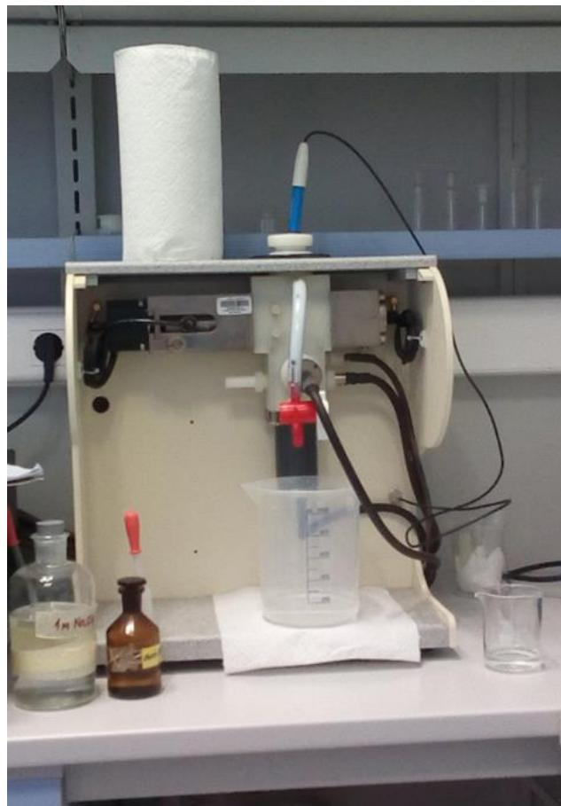
**Slika 29.** Akustični i elektroakustični spektrometar DT-1200, Dispersion Technology
