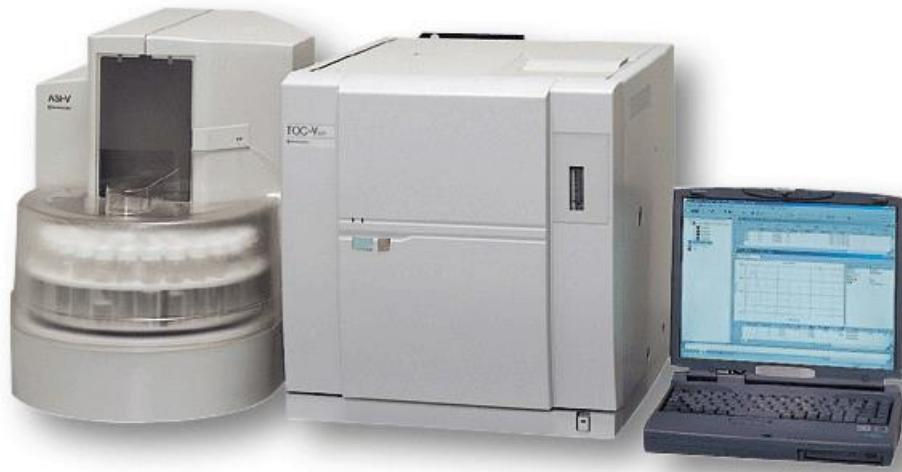
**Slika 44.** TOC analizator, Shimadzu TOC V-CPH
