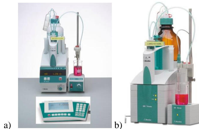
Slika 21. A) Prikaz aparature koja se koristila tijekom direktne potenciometrije i; b) Prikaz aparature koja se koristila tijekom potenciometrijske titracije.
