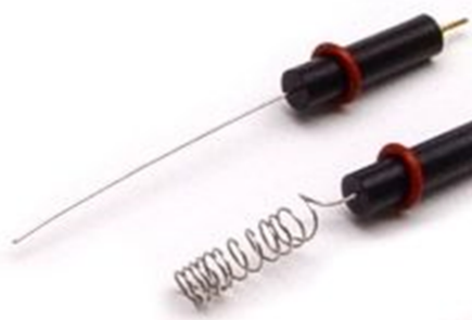
Slika 3.3. Protuelektroda – platinska žica.
