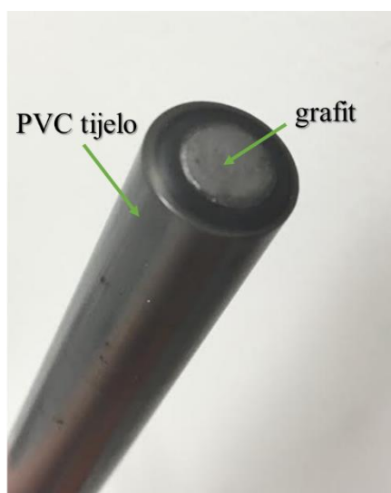
Slika 23: Izgled tijela senzora [5].
