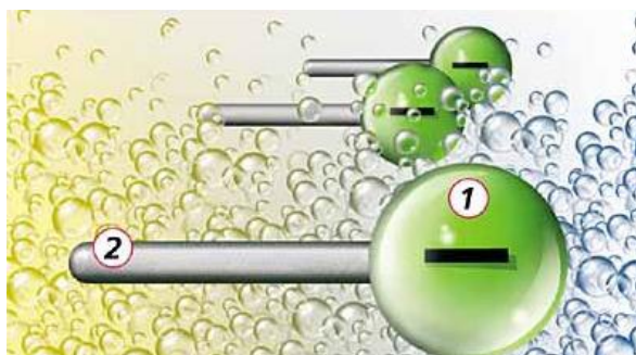
Slika 1: Shematski prikaz molekule tenzida: 1. hidrofina glava, 2. hidrofobni rep [4].
