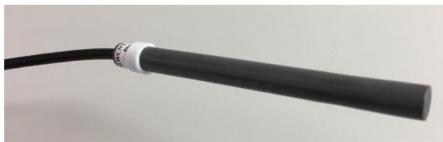
Slika 25: Izgled ionsko-selektivne elektrode za kationske tenzide sa čvrstim kontaktom i tekućom membranom [5].
