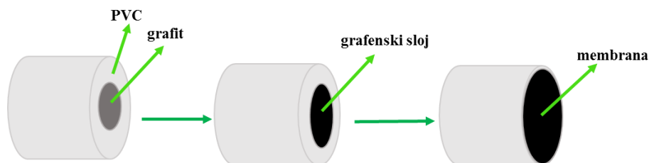
Slika 24: Shema senzora s čvrstim kontaktom i tekućom membranom [5].
