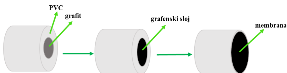
Slika 24: Shema senzora s čvrstim kontaktom i tekućom membranom [5].
