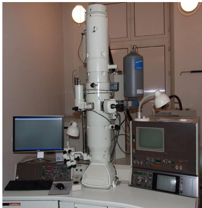
Slika 10. Transmisijski elektronski mikroskop. [25]
