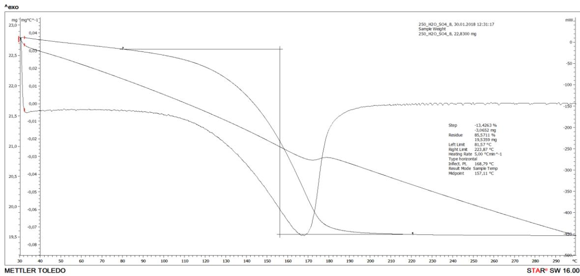
**Slika 18.** Termogram uzorka nakon 2h sinteze s dodatkom H<sub>2</sub>O na brzini 250 ok/min.
