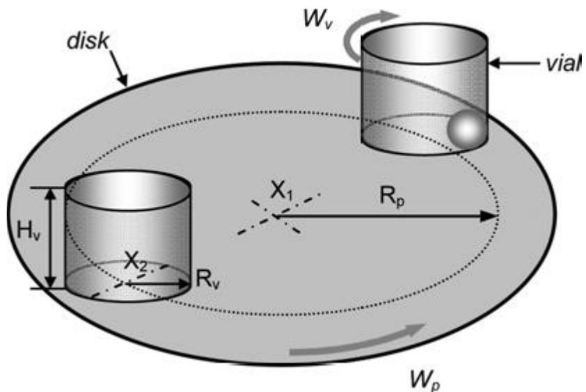
**Slika 3.** Prikaz vrtnje planetarnog kugličnog mlina<sup>[16]</sup>.
