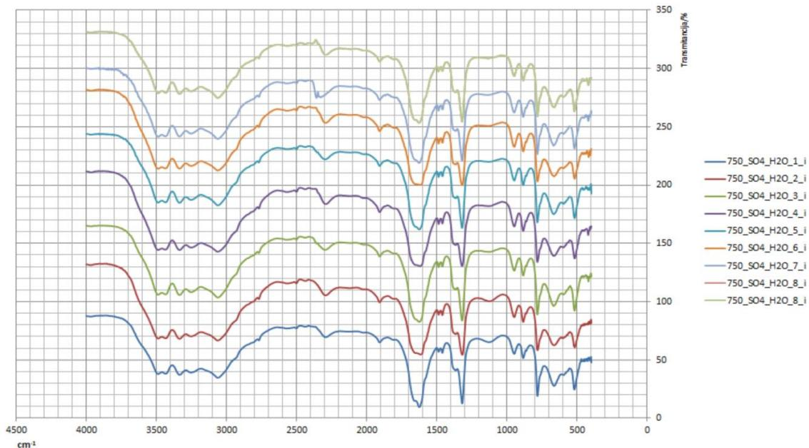
**Slika 32.** FT-IR spektar uzorka nakon ispiranja sa dodatkom vode na 750 ok/min.
