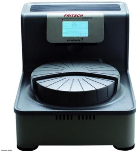
**Slika 8.** Planetarni mlin korišten kod sinteze kalcijeva oksalata.
