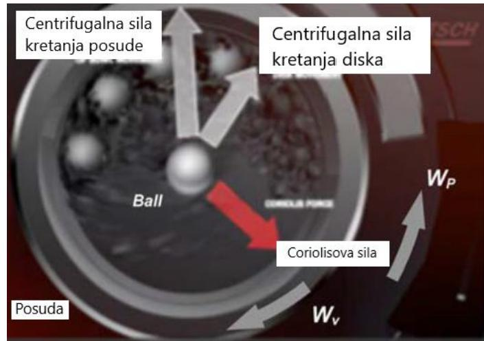
**Slika 4.** Prikaz sila koje djeluju u reakcijskoj posudi planetarnog kugličnog mlina.
