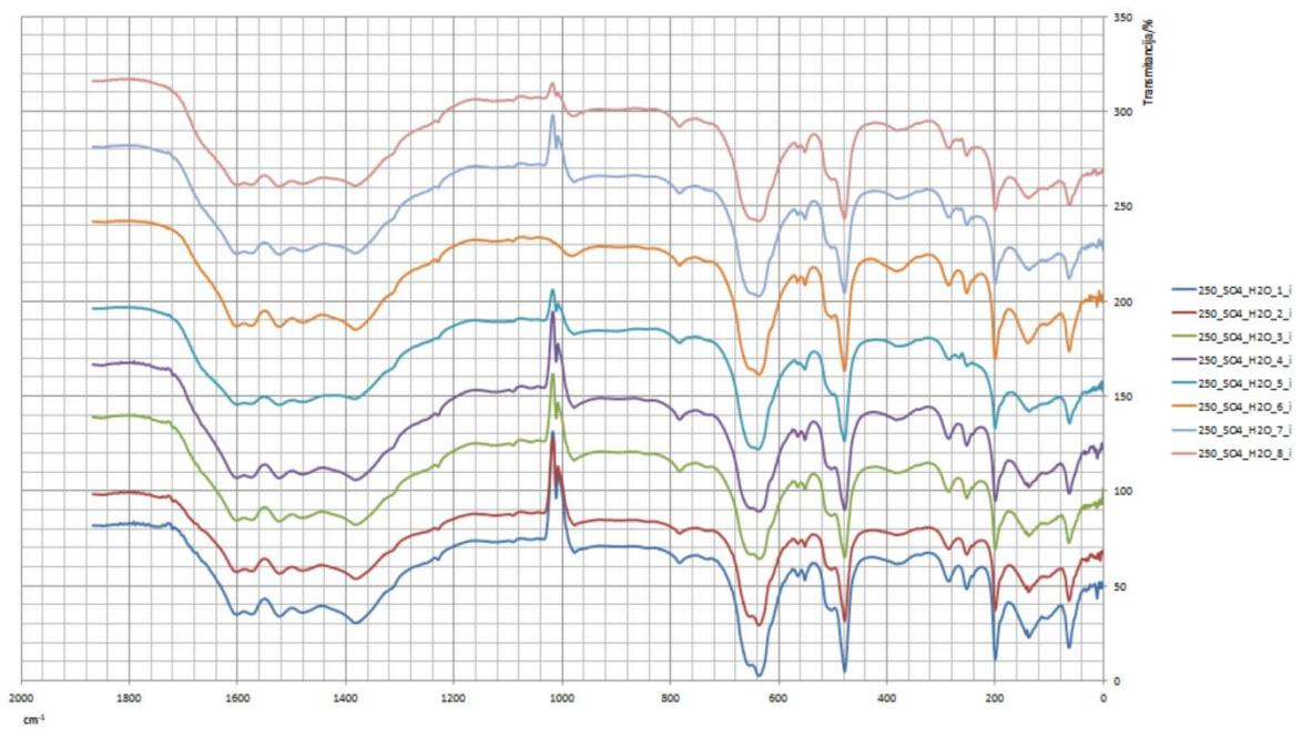
**Slika 16.** FT-IR spektar uzorka sa dodatkom vode nakon ispiranja na  $250\text{ ok/min}$ .
