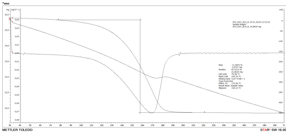
**Slika 26.** Termogram uzorka uzetog nakon 2h sinteze s dodatkom H<sub>2</sub>O na brzini 500 ok/min.
