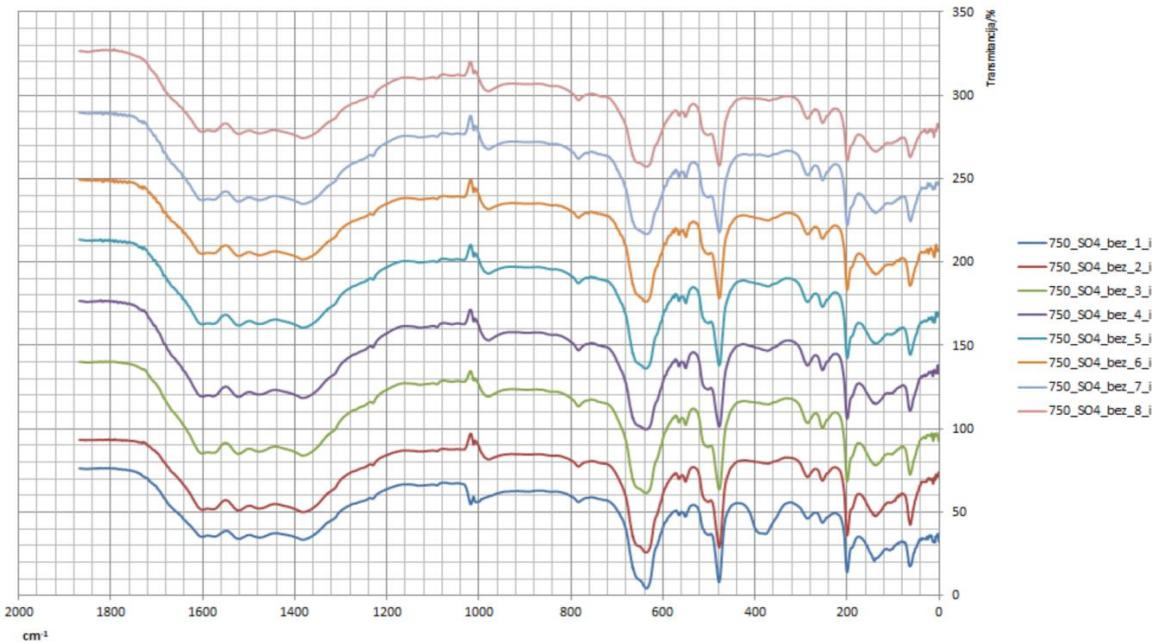
**Slika 31.** FT-IR spektar uzorka bez dodatka vode nakon ispiranja na 750 ok/min.
