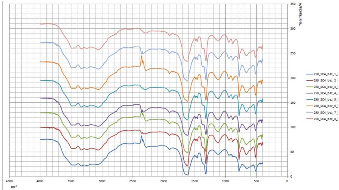
**Slika 15.** FT-IR spektar uzorka bez vode nakon ispiranja na  $250\text{ ok/min}$ .
