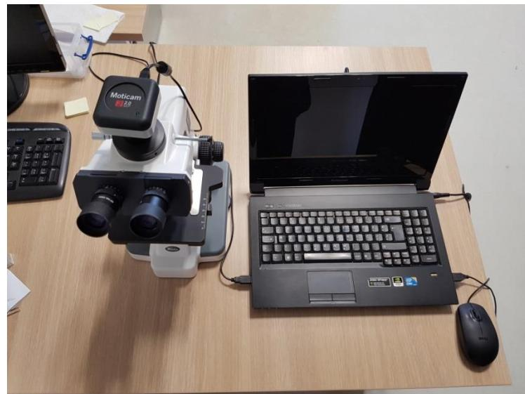
**Slika 12.** Aparatura za optičku mikroskopiju.
