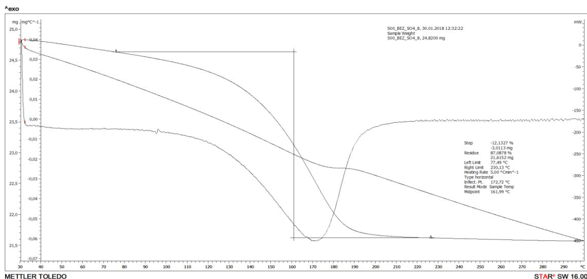
**Slika 25.** Termogram uzorka uzetog nakon 2h sinteze bez dodatka H<sub>2</sub>O na brzini 500 ok/min.
