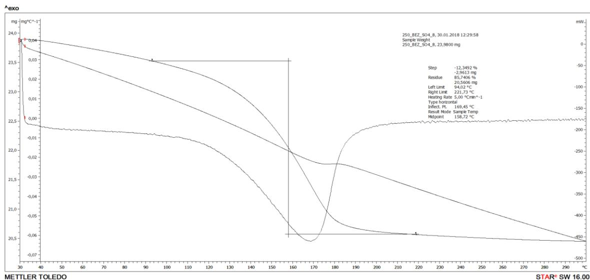
**Slika 17.** Termogram uzorka nakon 2h sinteze bez dodatka H<sub>2</sub>O na brzini 250 ok/min.
