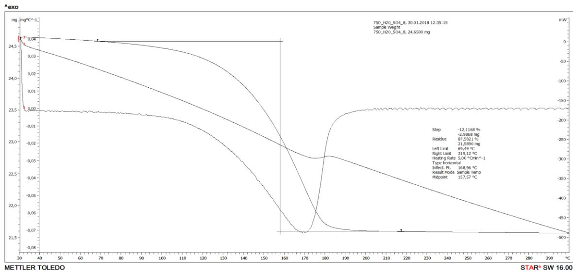
**Slika 34.** Termogram uzorka uzetog nakon 2h sinteze sa dodatkom  $\text{H}_2\text{O}$  na brzini 750 ok/min.
