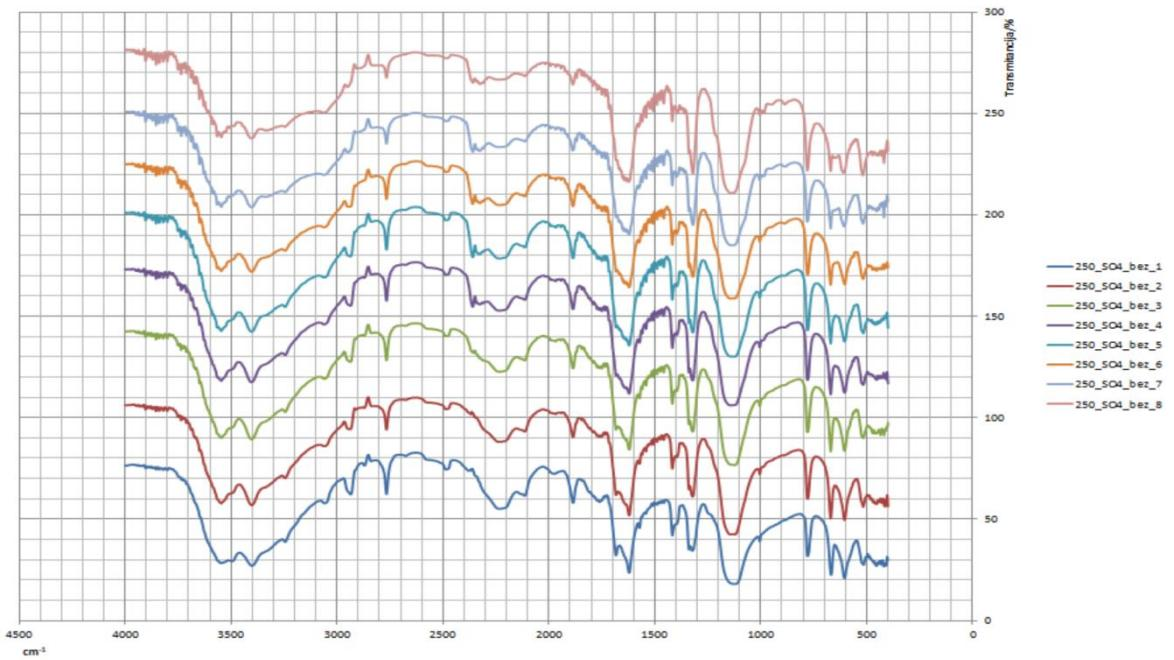
**Slika 13.** FT-IR spektar uzoraka bez dodavanja vode na 250 ok/min.
