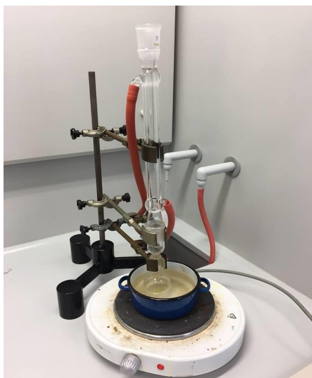
Slika 14. Aparatura: tikvica s kemikalijama, vodena kupelj, hladilo i refluks.
