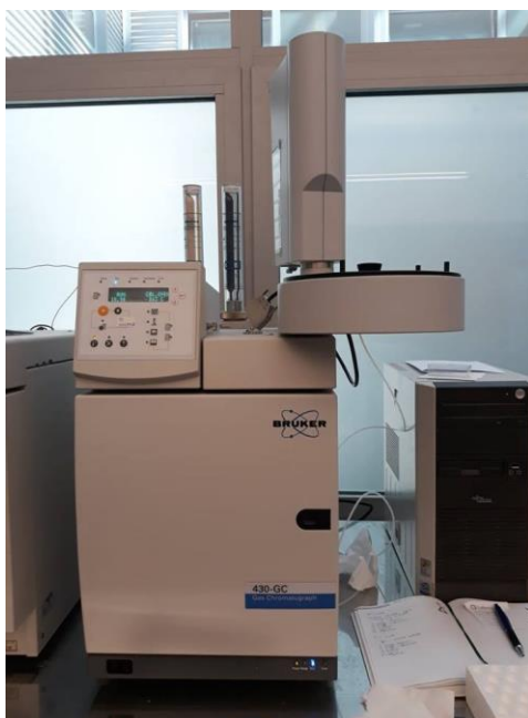
Slika 11. Plinski kromatograf tvrtke Bruker, model 430-GC.
