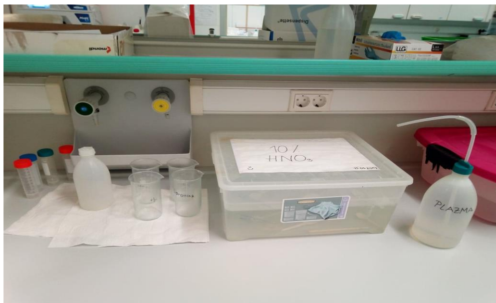
Slika 4. Posuda s 10% HNO 3 za skladištenje potrebnog posuđa.
