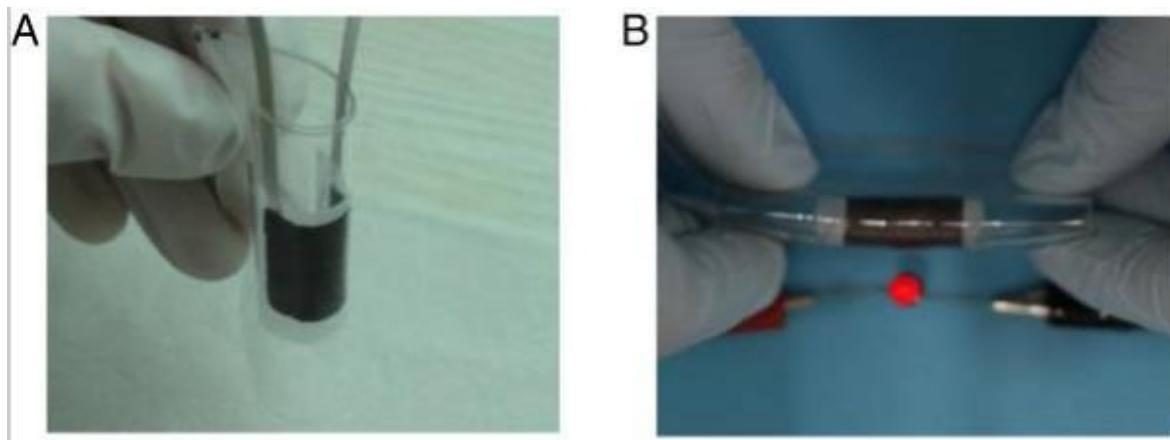
Slika 11. A) Savijanje baterije-fleksibilne karakteristike B) osvjetljavanje crvenog LED svjetla pod savijanjem.<sup>16</sup>
