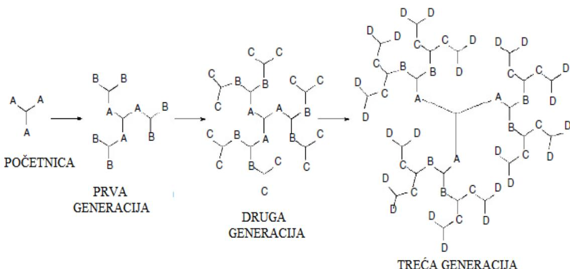
Slika 10. Shematski prikaz dobivanja dendrimera uzastopnim ponavljanjem (divergentno)<sup>1</sup>
