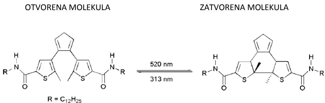
Slika 4. Primjer molekulskog prekidača(ditienilciklopentenski spojevi) koji reagira na valnu duljinu UV zračenja.<sup>1</sup>
