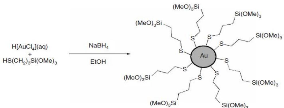
**Slika 6. Prikaz nastajanja nanočestica zlata procesom redukcije  $\text{H}[\text{AuCl}_4]$  uz natrijev borhidrid.<sup>1</sup>**
