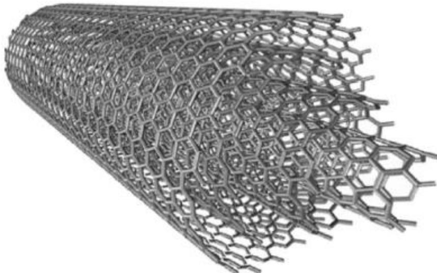
Slika 9. Prikaz višestjenčane(multi-walled) nanocjevčice koja se sastoji od grafenskih listova, koji zajedno čine koncentričan cilindar<sup>9</sup>
