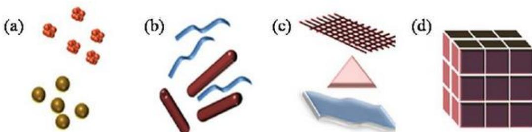
**Slika 5. Prikaz klasifikacije nanomaterijala:** a) 0D sfere i klasteri; b) 1D nanovlakna, nanožice; c) 2D nanofilmovi i nanomreže; d) 3D nanomaterijali.<sup>8</sup>
