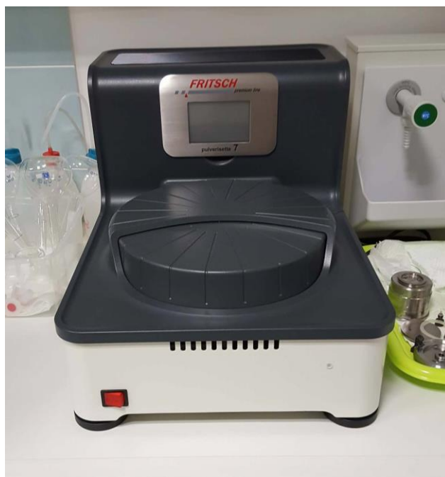
Slika 8. Rotacijski planetarni kuglični mlin
