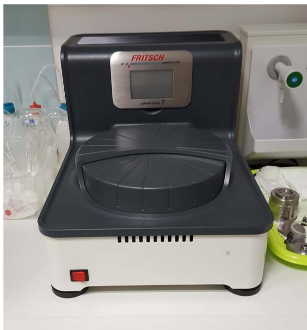
Slika 8. Rotacijski planetarni kuglični mlin
