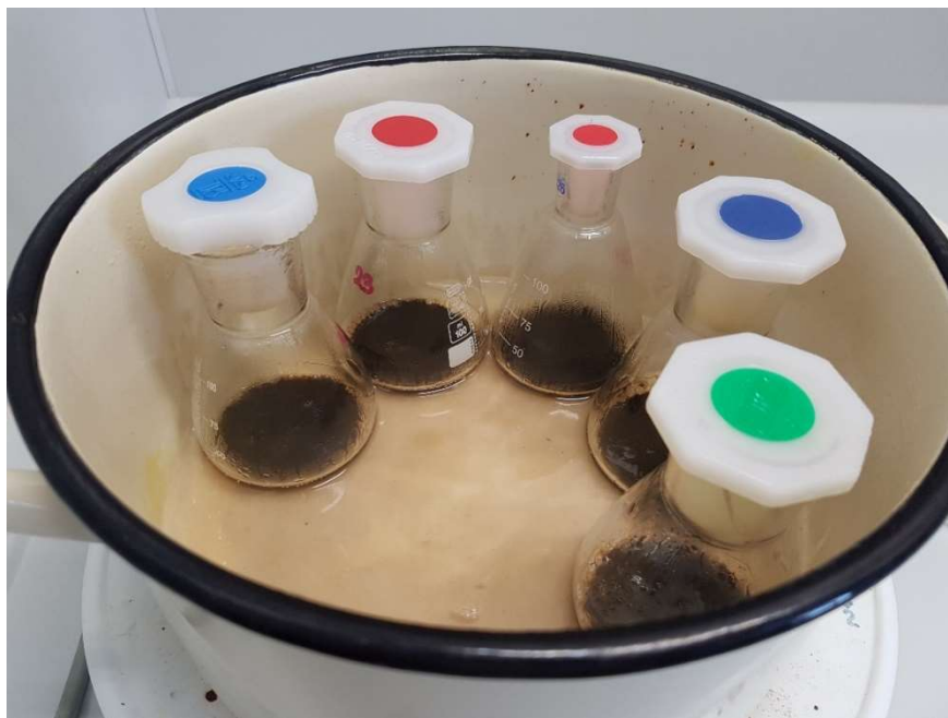
Slika 9. Zagrijavanje otopine žumanjka i HCl na vodenoj kupelji.
