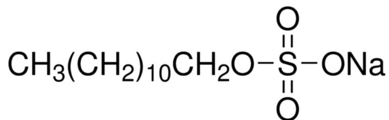
Slika 5. Primjer anionskog tenzida (natrijev dodecil sulfat) [10]
