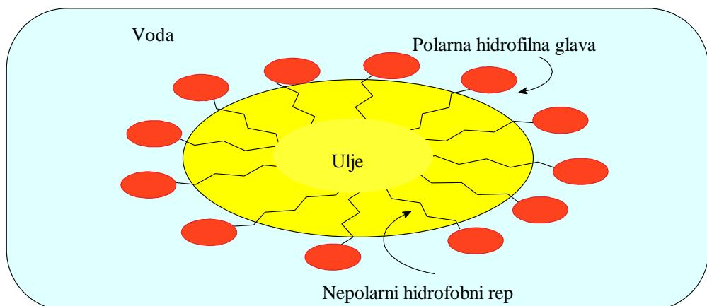
Slika 2. Adsorpcija tenzida na ulju (slika izrađena u ACD/Chem Sketch programu)
