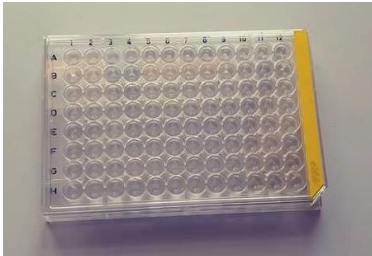
Slika 12. Pločica s jažicama u koju se stavljaju uzorak i otapalo te se stavlja u uređaj za mjerenje fluorescencije.
