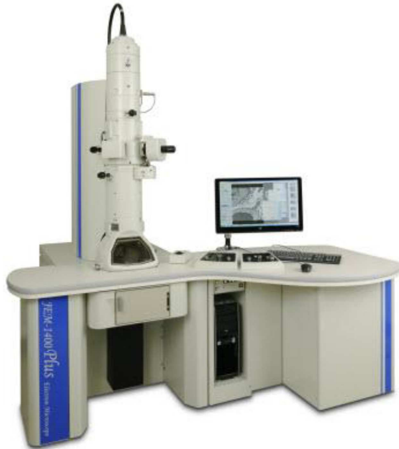
Slika 17. Transmisijski elektronski mikroskop [30]
