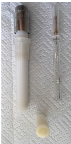
Slika 12. Prikaz dijelova tijela Philipsove elektrode.
