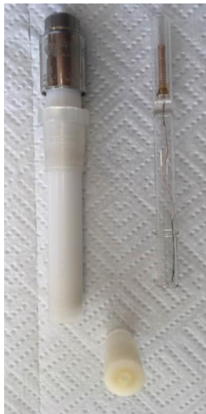
Slika 12. Prikaz dijelova tijela Philipsove elektrode.
