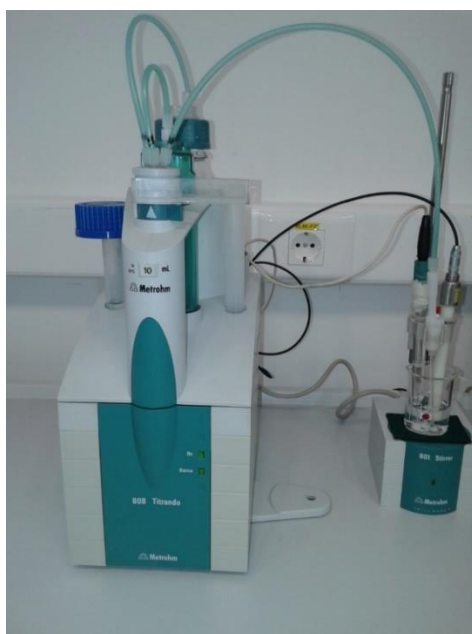
Slika 7. Prikaz instrumenta koji je korišten za potenciometrijske titracije (Titrando 808).
