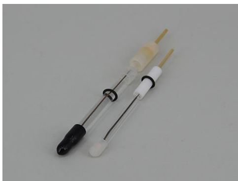
Slika 18. Ag/AgCl referentna elektroda [39].
