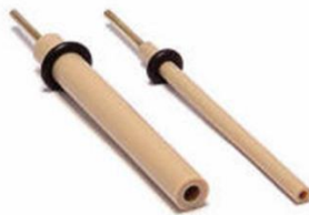
Slika 16. Elektroda od staklastog ugljika [38].
