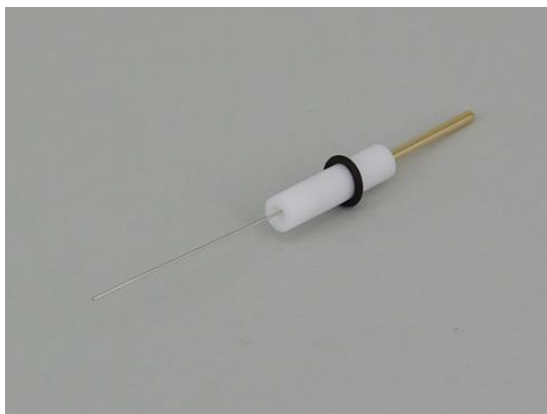
Slika 19. Protuelektroda platinska žica [32].
