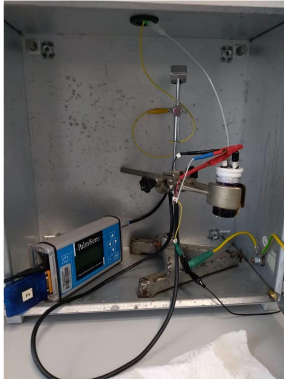
Slika 15. Elektrokemijska ćelija s troelektrodnim sustavom.
