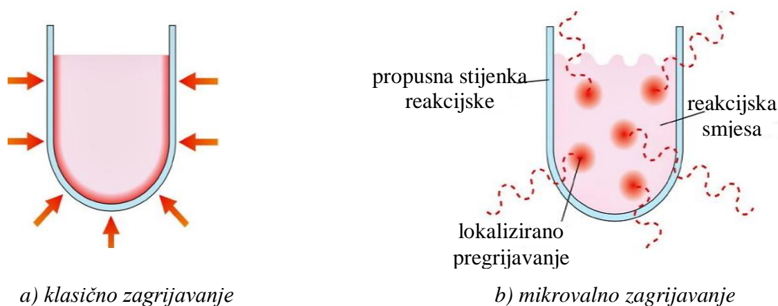
Slika 2.7. Usporedba zagrijavanja uzorka klasičnim (a) i mikrovalnim (b) zagrijavanjem
