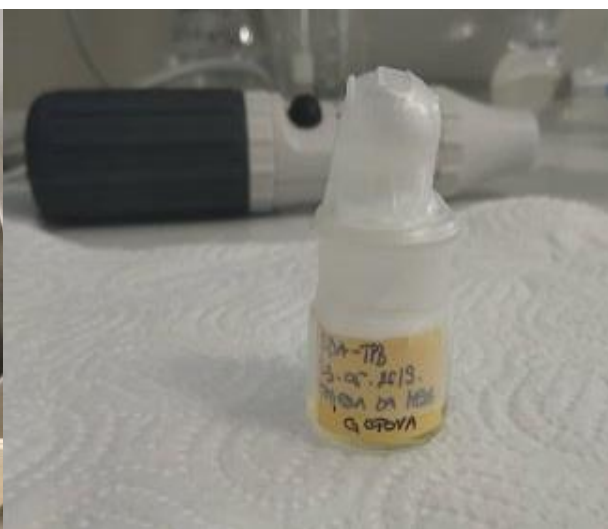
Slika 18. Pripravljena tekuća membrana.
