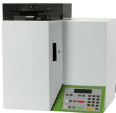
Slika 9. Uređaj za CHNS analizu [21]
