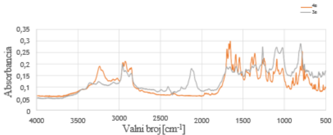
Slika 30. FTIR spektar spojeva 3a i 4a .
