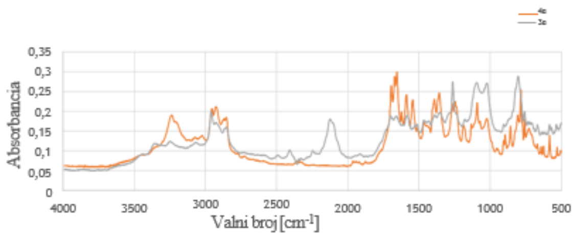
Slika 30. FTIR spektar spojeva 3a i 4a .
