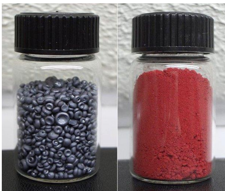
Slika 2. Alotropske modifikacije selenija.
