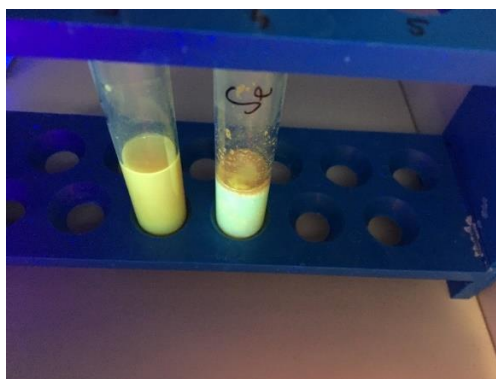
Slika 27. Kompleksiranje ciljnog produkta sa selenijem.
