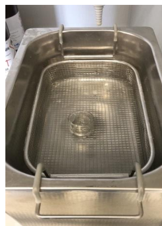
Slika 23. Otopanje smjese na ultrazvučnoj kupelji
