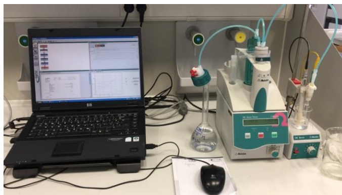
Slika 26. Univerzalni titrator 794 Basic titrino korišten za potenciometrijske titracije
