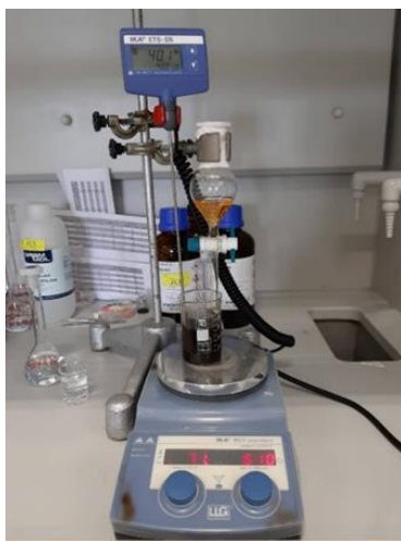
Slika 12. Prikaz koprecipitacijske metode sinteze nanočestica kobalt ferita.
