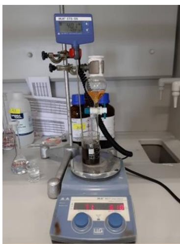
Slika 12. Prikaz koprecipitacijske metode sinteze nanočestica kobalt ferita.
