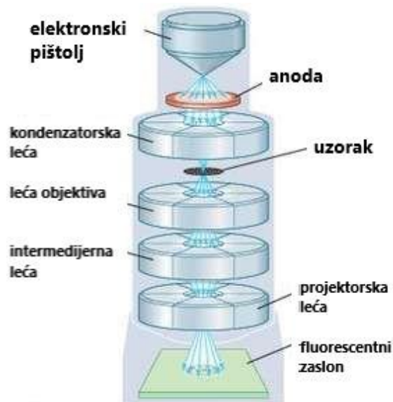
Slika 7. Shematski prikaz komponenta TEM-a [61].
