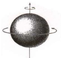
Slika 16. Vrtnjom nabijene jezgre, ^1\text{H} atoma, inducira se magnetski dipol [30].
