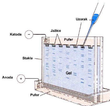
Slika 8. Shematski prikaz poliakrilamidnog gela između stakala prilikom nanošenja uzorka na gel [25].
