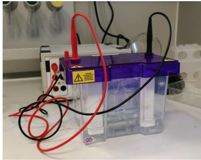
Slika 9. Uređaj za elektroforezu spojen na protok struje.
