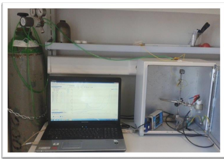
Slika 15. Aparatura za voltametrijska mjerenja, PalmSens potenciostat/galvanostat u Faradayevom kavezu.
