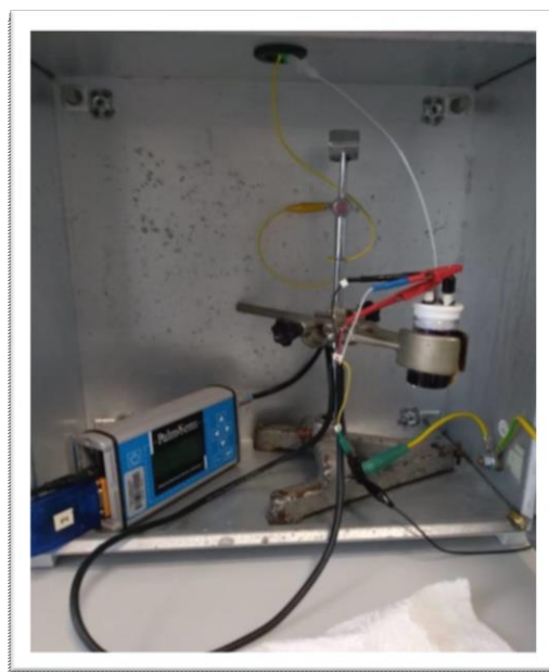
Slika 16. Elektrokemijska ćelija s troelektrodnim sustavom.
