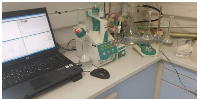
Slika 5. 794 Basic Titrino, aparatura za titraciju
