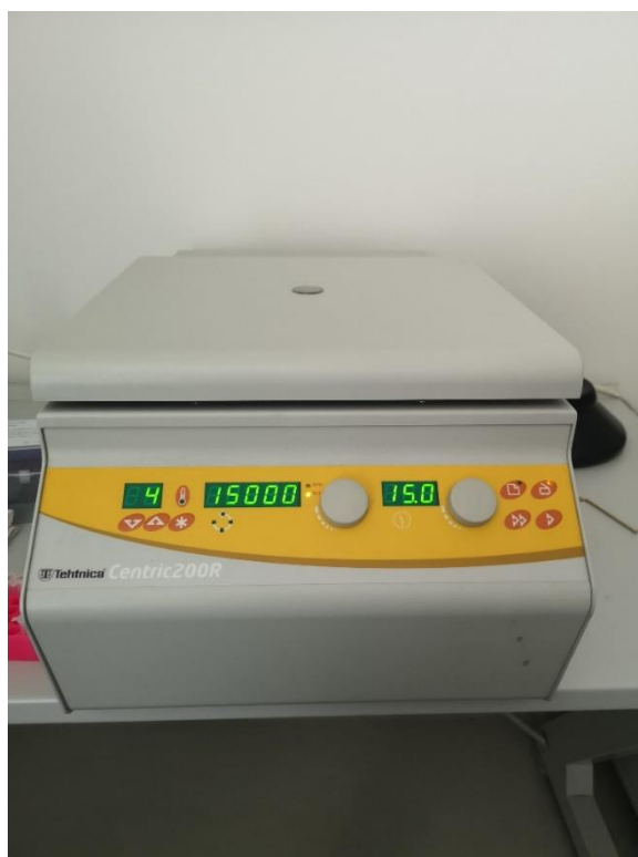
Slika 5: aparat za centrifugiranje
