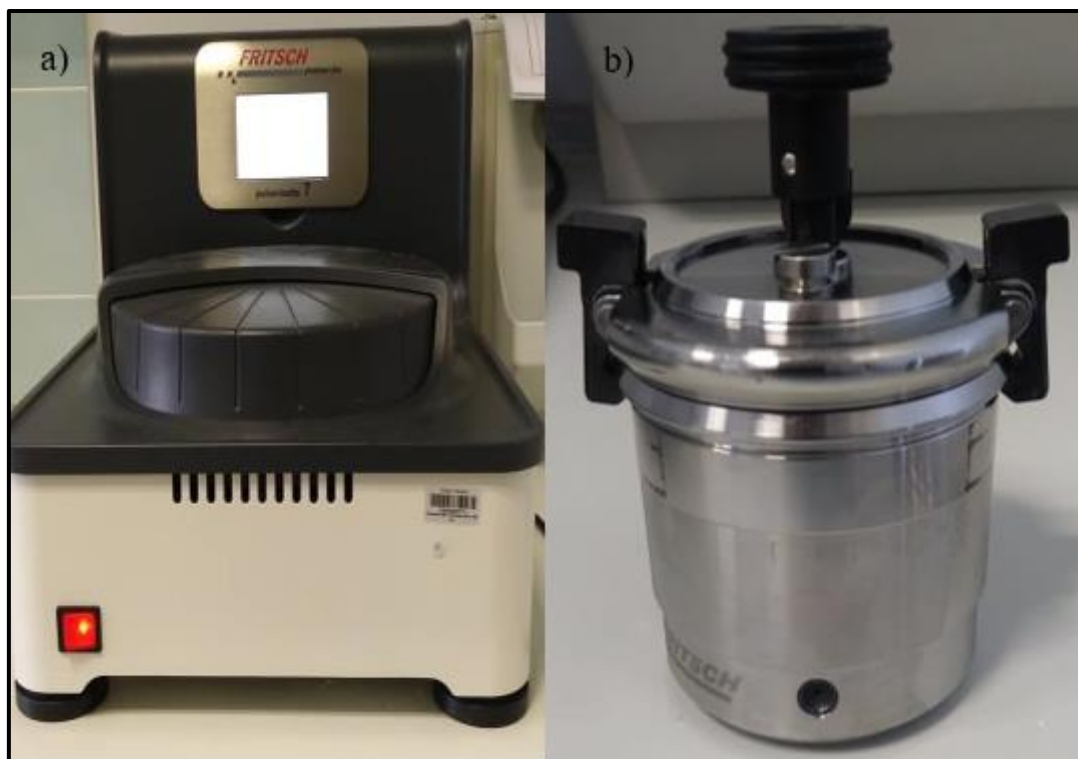
Slika 20. a) Planetarni kuglični mlin Fritsch Pulverisette Premium 7 line; b) Reaktor volumena 20 mL.
