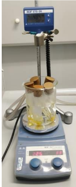
Slika 18.: Vodena kupelj s uzorcima
