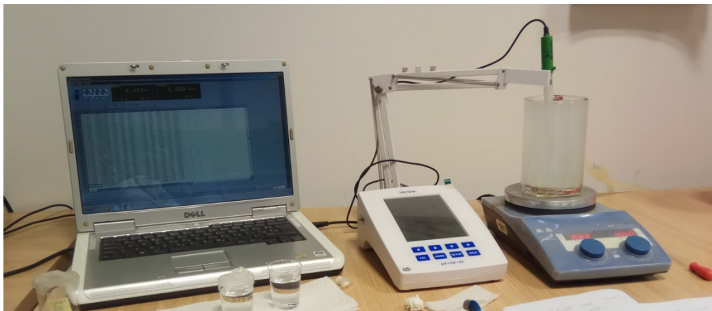
Slika 11. Slika aparature za određivanje pH vrijednosti ispitivanih otopina.
