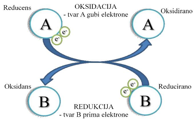
Slika 1. Shematski prikaz oksidacijsko – redukcijskog procesa.
