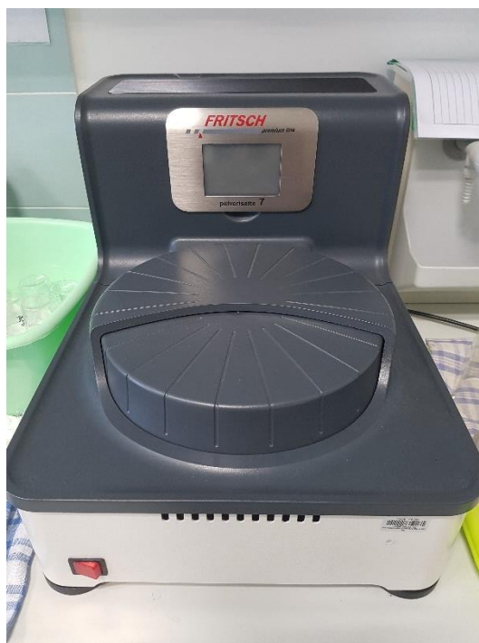
Slika 17. Planetarni kuglični mlin korišten u sintezi trostrukog perovskita \text{Ca}_3\text{Fe}_2\text{WO}_9 .
