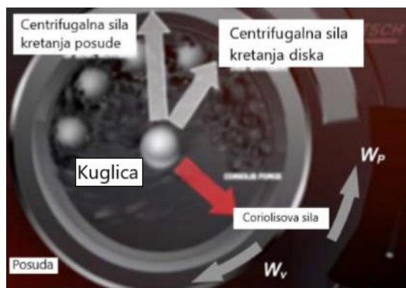
Slika 11. Sile unutar reakcijske posude planetarnog kuglično mlina [24].
