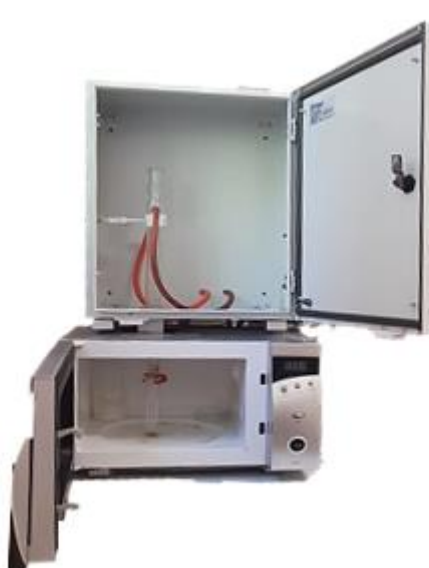
Slika 23. Modificirana kućna mikrovalna pećnica marke Electrolux EMS 2105.
