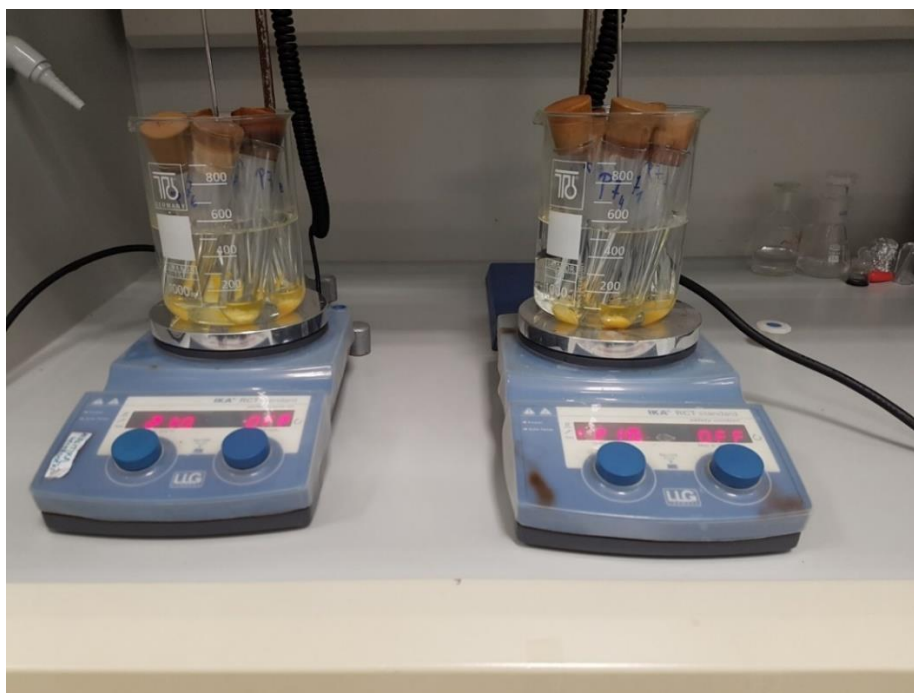
Slika 17. Uzorak žumanjka s kalijevim hidroksidom u vodenoj kupelji.
