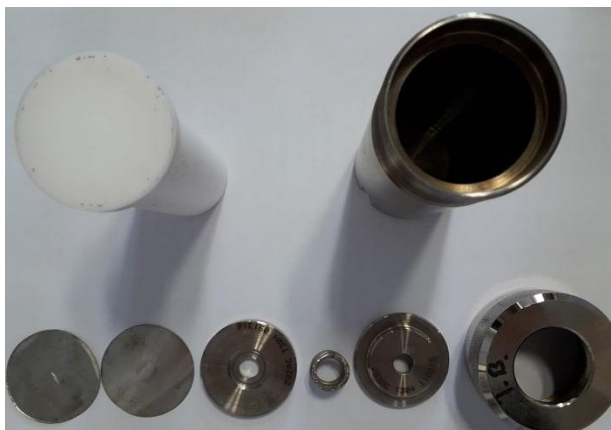
Slika 25. Dijelovi hidrotermalnog reaktora (autoklava).
