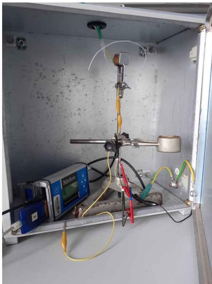
Slika 27. Potenciostat/galvanostat korišten za cikličku voltametriju.
