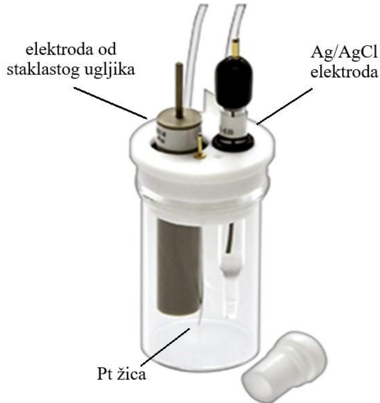
Slika 17. Prikaz elektroda na troelektrodnoj voltametrijskoj ćeliji. Elektroda od staklastog ugljika - radna elektroda, Ag/AgCl - referentna elektroda, platinska žica - protuelektroda [43].
