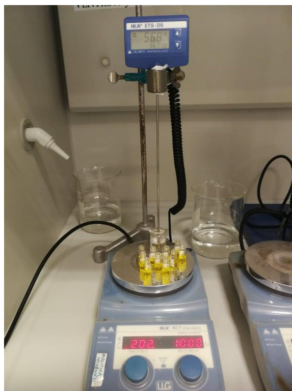
Slika 19. Zagrijavanje uzoraka na temperaturi vrelišta acetona.
