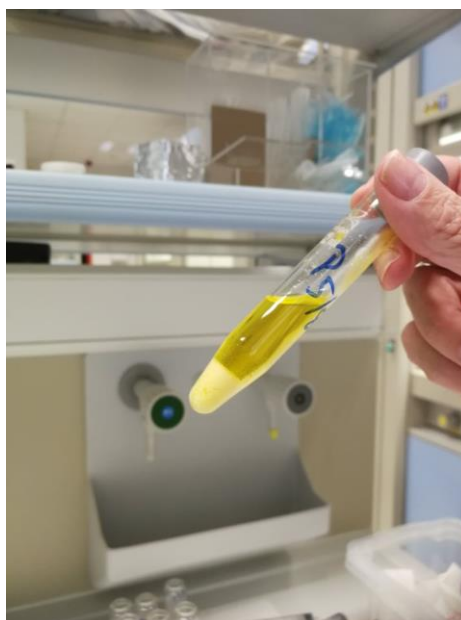
Slika 18. Izdvajanje luteina iz žumanjka dodatkom acetona.
