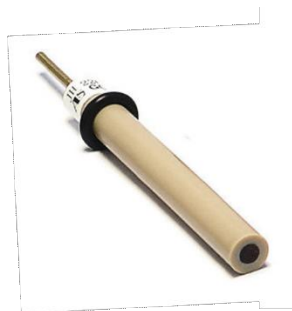
Slika 26. Radna elektroda od staklastog ugljika (GC-elektroda).
