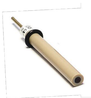
Slika 26. Radna elektroda od staklastog ugljika (GC-elektroda).
